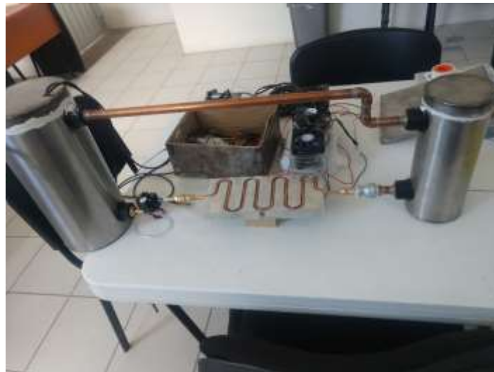
Figura 23. Sistema completo de condensación.
