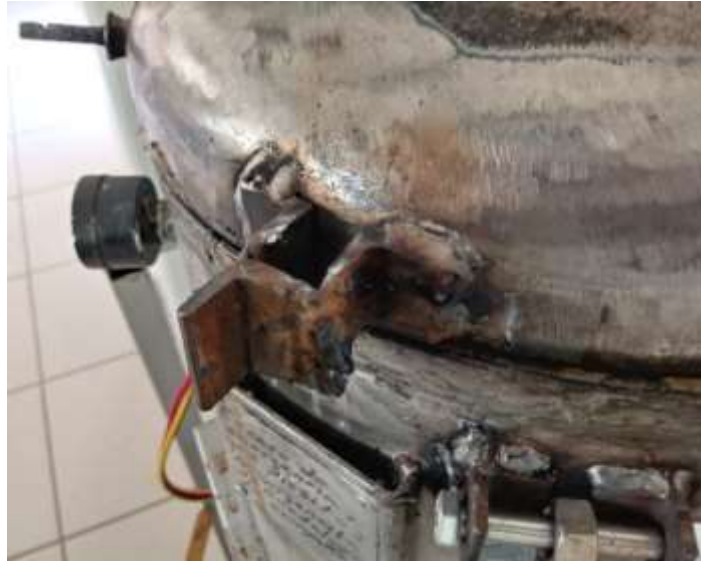
Figura 21. Anclas de sujeción con reingeniería para los tornillos de sujeción.
