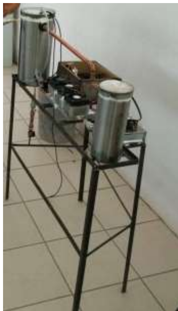
Figura 24. Sistema completo de condensación en su estructura de soporte.
