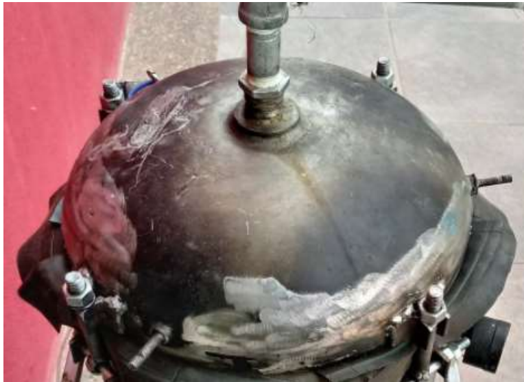
Figura 20. Tapa de reactor con el empaque de hule hecho a la medida.
