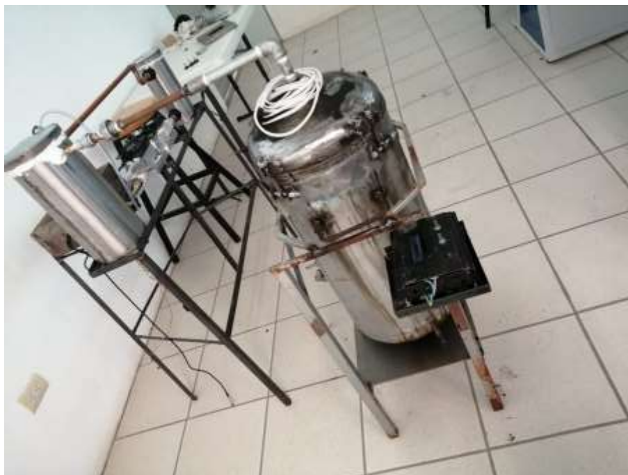
Figura 43. Equipo completo original (reactor más condensador).
