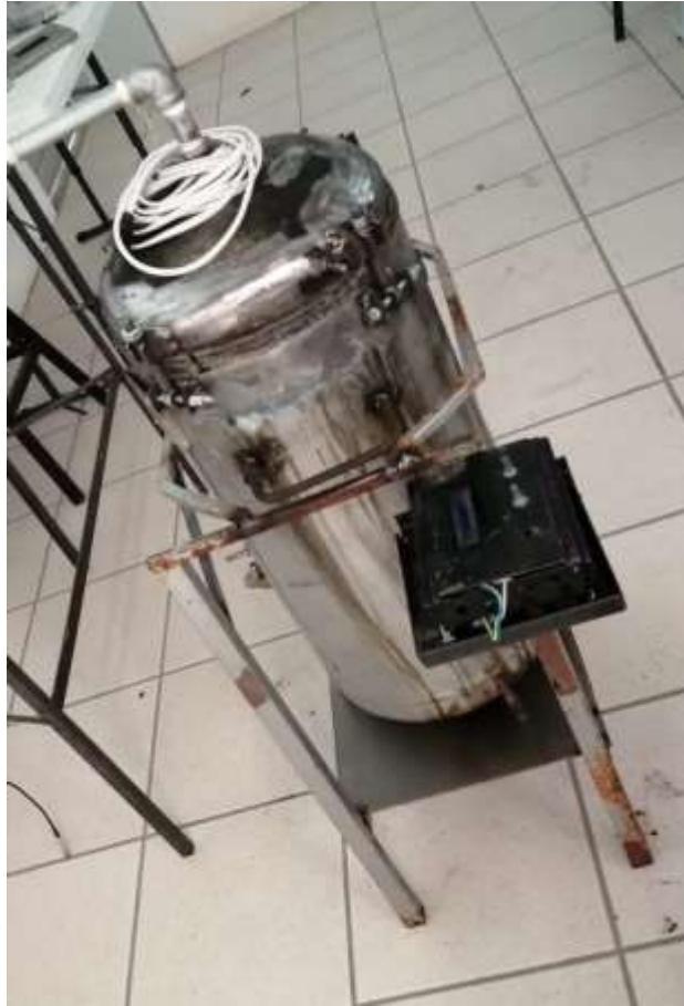
Figura 19. Reactor pirolítico automatizado de prueba.
