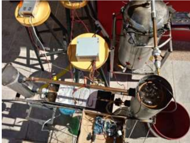
Figura 49. Prueba con enfriamiento en el cilindro y en los disipadores de las celdas Peltier.
