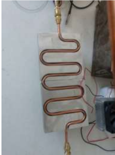
Figura 25. Placa de aluminio con la tubería de cobre que recibirá el enfriamiento.
